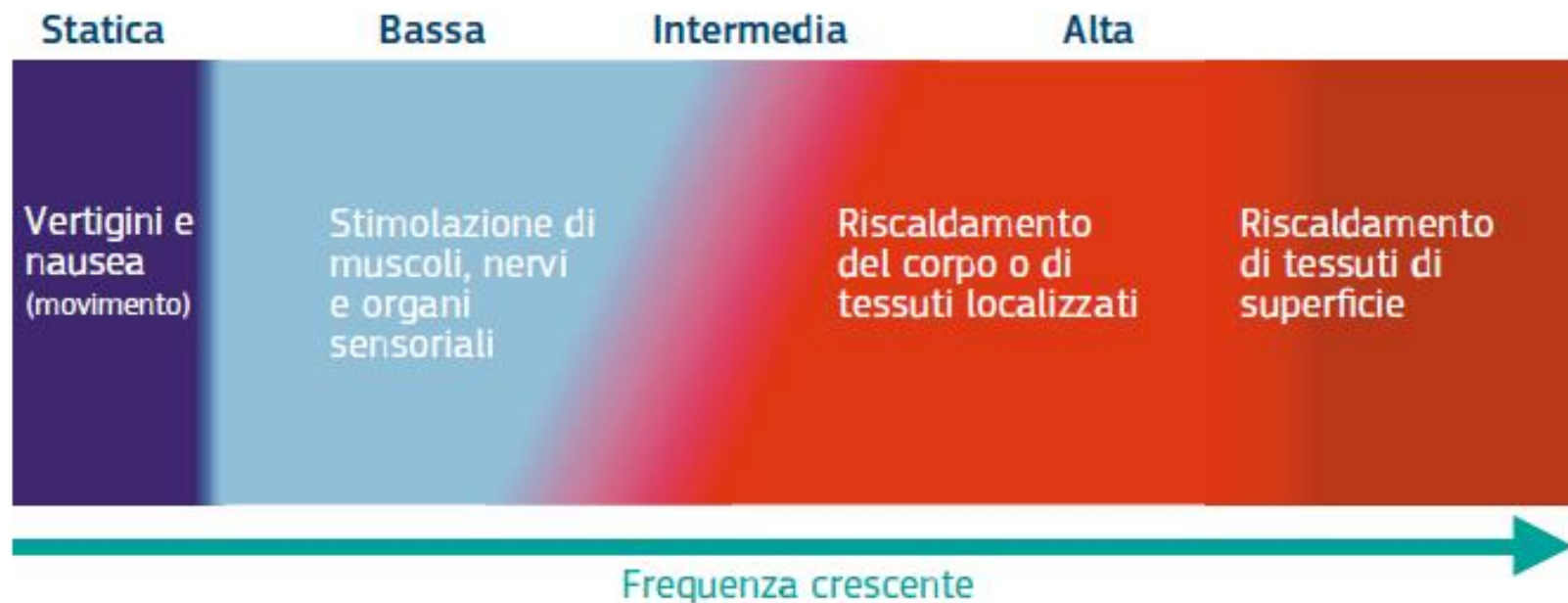
Figura 2.1 — Effetti dei campi elettromagnetici con diverse gamme di frequenza (gli intervalli di frequenza non sono in scala)
